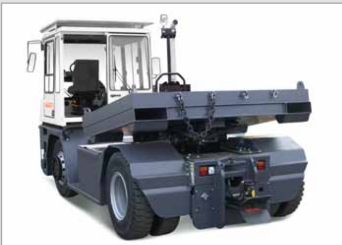
mit abnehmbarem Ballastgewicht auf der Sattelplatte
