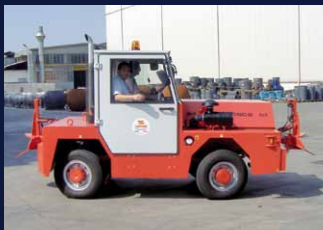
Versione a 4 ruote sterzanti per ridurre il diametro di sterzata. Version with 4 wheel steering system to reduce the turning radius.
