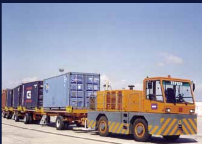
Versione potenziata con sforzo al gancio fino a 24000 kg. Heavy version with drawbar pull up to 24000 kg.
