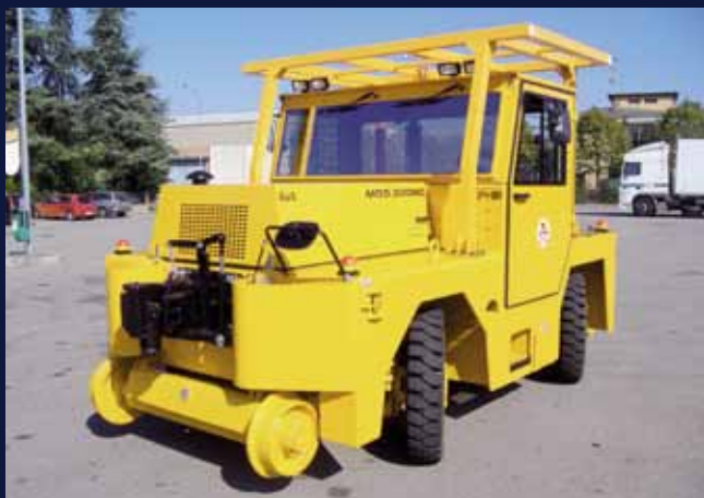
Versione per effettuare il traino su rotaia. Railroad version.
