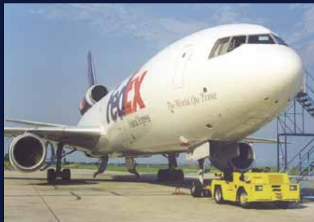
Versione ribassata (senza cabina) per il traino di aeroplani. Low profile version (without cabin) for the aircraft towing.
