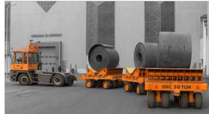
» Industrieanhänger mit Coilauflage und MAFI-Zugmaschine
