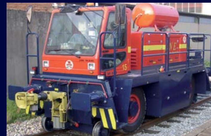
LOK 14.240 with air capacity for the pneumatic braking release increased to 1000 liters. LOK 14.240 mit Luftleistung für das pneumatische Wagonbremssystem von 1000 Liter. LOK 14.240 с мощностью пневмосистемы для снятия пневматических тормозов 1000л.
