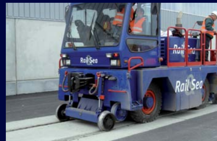
LOK 10.170 with double gauge of 1435 and 1520 mm. LOK 10.170 mit doppelter Gleisachse 1435 und 1520 mm. LOK 10.170 с двойной шириной колеи 1435 и 1520 мм.
