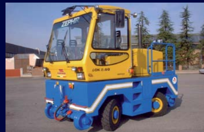
LOK 2.60 with reduced dimensions and 4 road wheel steering system. LOK 2.60 mit reduzierten Abmessungen und 4 Straßen-Allradlenkung. LOK 2.60 с уменьшенными габаритами и управлением на 4 колеса.
