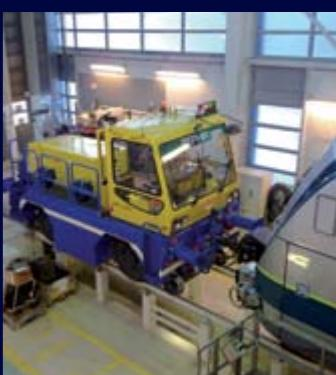
Capacity up to 2600 t · Zugkraft bis 2600 t · Тяговая мощность до 2600т
